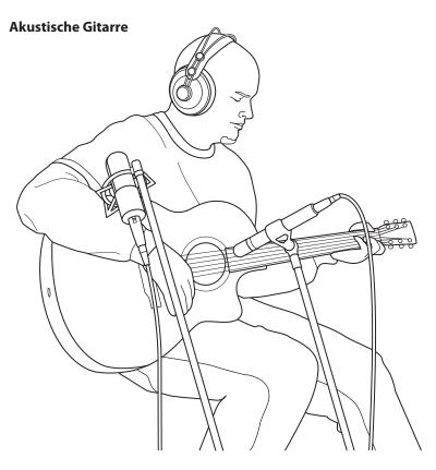
Richten Sie ein Kleinmembran-Kondensatormikrofon in einer Entfernung von etwa 20 cm auf den 12. Bund der Gitarre aus. Richten Sie zudem ein Großmembran-Kondensatormikrofon auf die Brücke der Gitarre aus: Die Entfernung sollte hier etwa 30 cm betragen. Experimentieren Sie mit den Abständen und der Ausrichtung der Mikrofone. Eine etablierte Methode ist auch die XY-Mikrofonierung mit zwei Kleinmembran-Kondensatormikrofonen. (Siehe Abbildung Drum-Overheads.)
